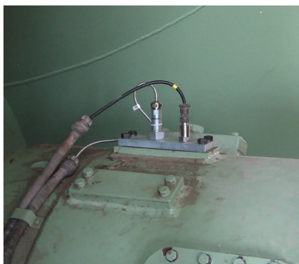
Mesures de vibration absolue de palier et de vibration relative d'arbre
