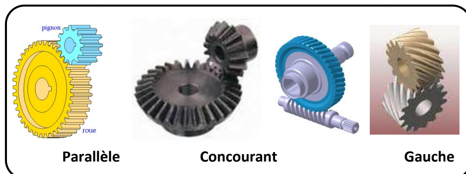
Figure 5.22 : Différents types d'engrenage
